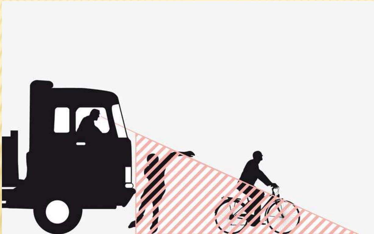
A l'avant, la vision du chauffeur est limitée dans le sens de la hauteur ainsi qu'à sa droite.
